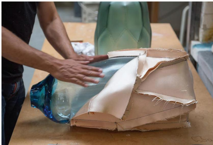
Fig. 2 Enlèvement du moule en textile-CIRVA,2015-2018
