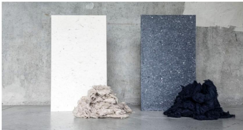
Fig. 6 *Pierreplume*, Premices & Co, 2020. Matériau acoustique en textile recyclé
