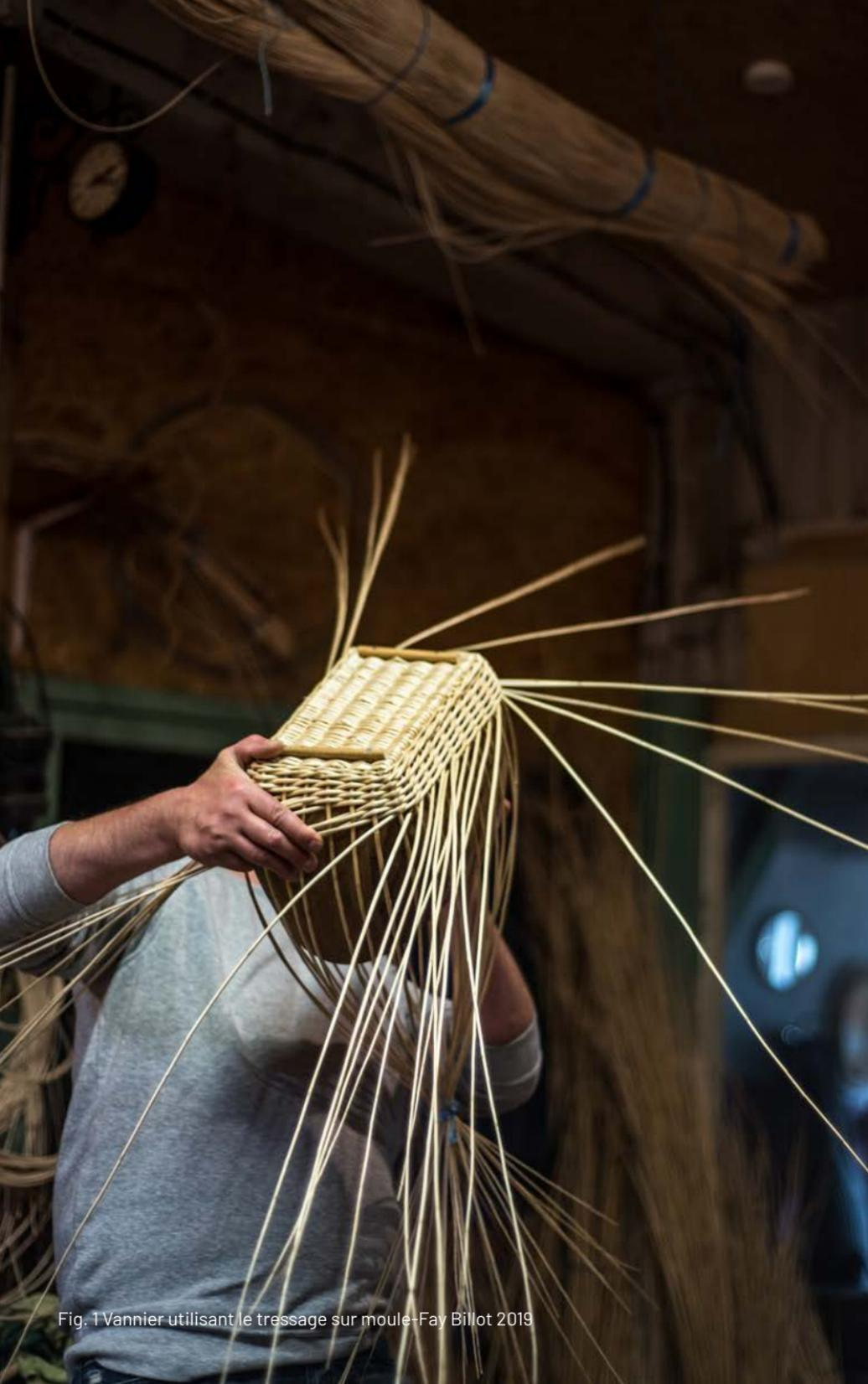
Fig. 1 Vannier utilisant le tressage sur moule-Fay Billot 2019
