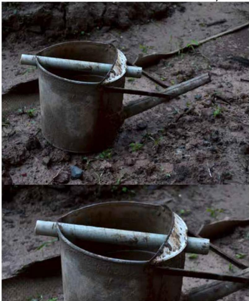
Bidon de récupération, tube et tôle soudés.
