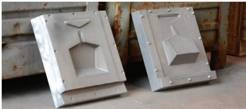
Fig. 8 Moules pour emboutissage par thermocompression, *Folie végétale*, 2016
